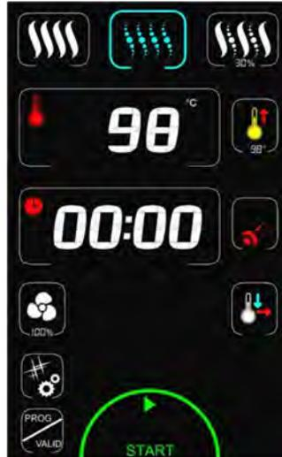
Les fonctions Humidification manuelle et Clapet Oura sont inactives : touches masquées
