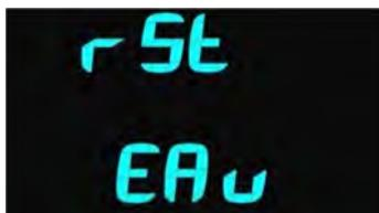
Ce message apparait à chaque mise sous tension si la capacité du système de traitement d'eau du four est atteinte.
