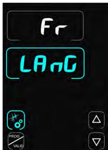
Un appui sur le paramètre permet de régler la valeur de celui-ci (de même qu'un appui sur la touche « PROG/VALID » ou sur le codeur)
